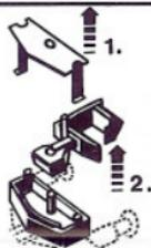
1. Mittels kleinem Schraubenzieher **Abdeckplatte** abziehen.
