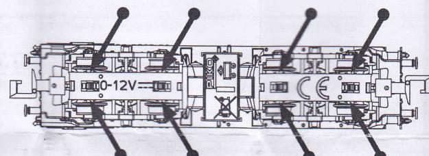
Ölen Sie bei häufigem Fahrbetrieb die Achslager mit einem Tropfen harz- und säurefreiem Nähmaschinenöl! Wir empfehlen, die Lok ca. 25 min je Fahrtrichtung ohne Belastung einlaufen zu lassen, damit das Modell einen optimalen Rundlauf und eine gute Zugkraft erhält. Bitte beachten Sie, daß der einwandfreie Lauf des Modells nur auf sauberen Schienen gewährleistet ist.
