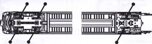
Ölen Sie bei häufigem Fahrbetrieb die Achslager mit einem Tropfen harz- und säurefreiem Nähmaschinenöl!
